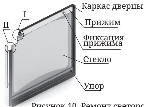
Рисунок 10. Ремонт светорозрачного экрана дверцы модификации «Витра»
